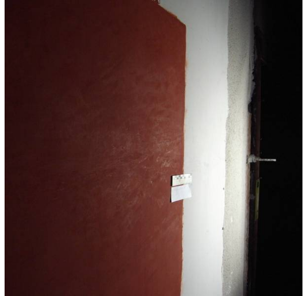
Abb. 29 Gruppe 1, Feld B nach Glättversuchen. Ansicht von der Seite, Glanzeffekt
