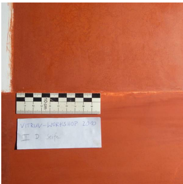
Abb. 34 Gruppe 2, Feld D (kleiner Bereich oben rechts mit Olivenseife) nach Glättversuchen
