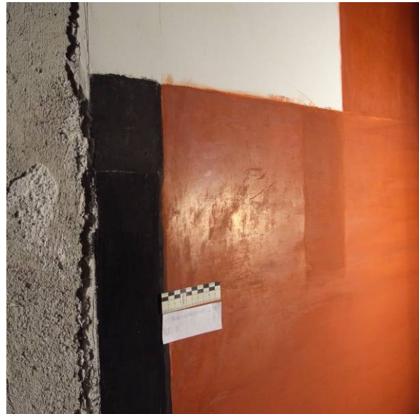
Abb. 33 Gruppe 2, Feld D nach Glättversuchen. Ansicht von der Seite, Glanzeffekt
