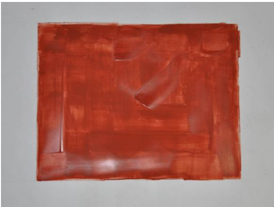
Abb. 15 Gruppe 2. 1. lasierender Farbauftrag
