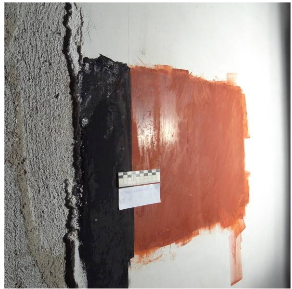
Abb. 37 Gruppe 2, Feld E nach Glättversuchen. Ansicht von der Seite, Glanzeffekt
