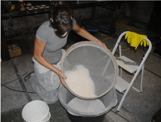
Abb. 11 Gruppe 1. Aufbereiten des Kalkspatzuschlags
