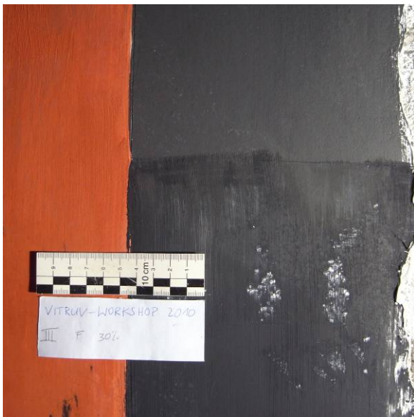
Abb. 40 Gruppe 3, Feld F (rechte Hälfte, 30% Kaolin in Feinschicht) nach Glättversuchen
