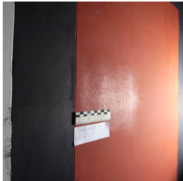
Abb. 46 Gruppe 4, Feld H nach Glättversuchen. Ansicht von der Seite, Glanzeffekt
