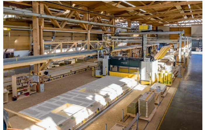
Abb. 2: moderne Produktionslinie einer Holzbauvorfertigung.
